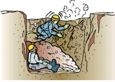
1.5m以上掘削は⇒土止め先行工法若しくは地山の種類に応じた安定勾配を確保する
